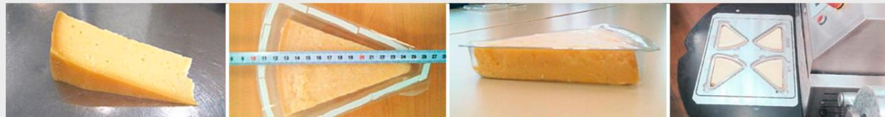
Entwicklungsbeispiel einer Käseverpackung in vorgefertigter Schale mit bedruckter Oberfolie, verpackt auf Rotarius VG
